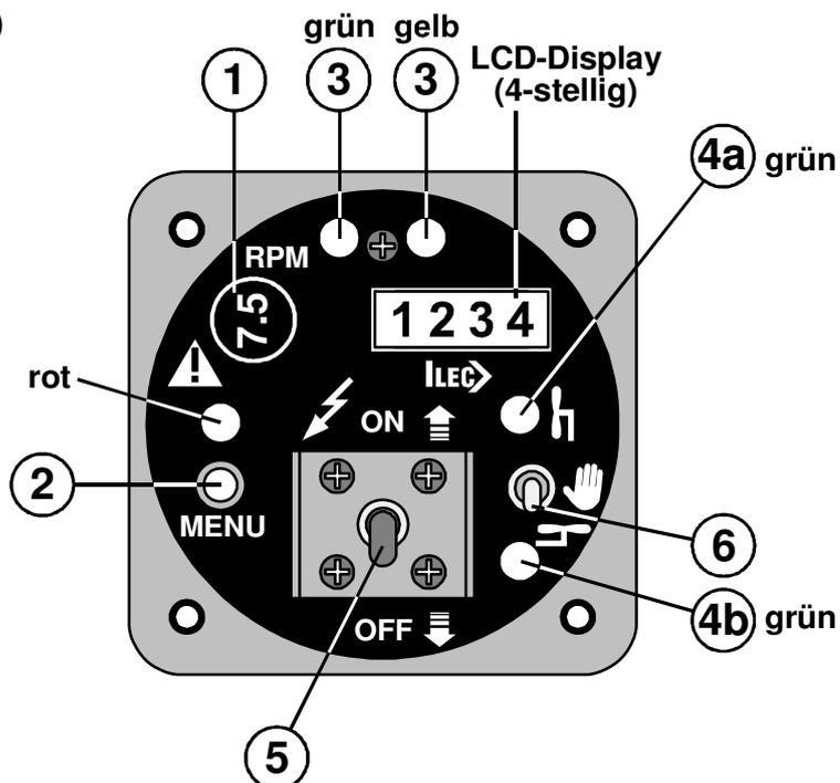
Die Triebwerks-Bedieneinheit TB 06 ermöglicht eine teilweise automatisierte Bedienung des Triebwerks beim Aus- und Einfahren und im Motorbetrieb.
